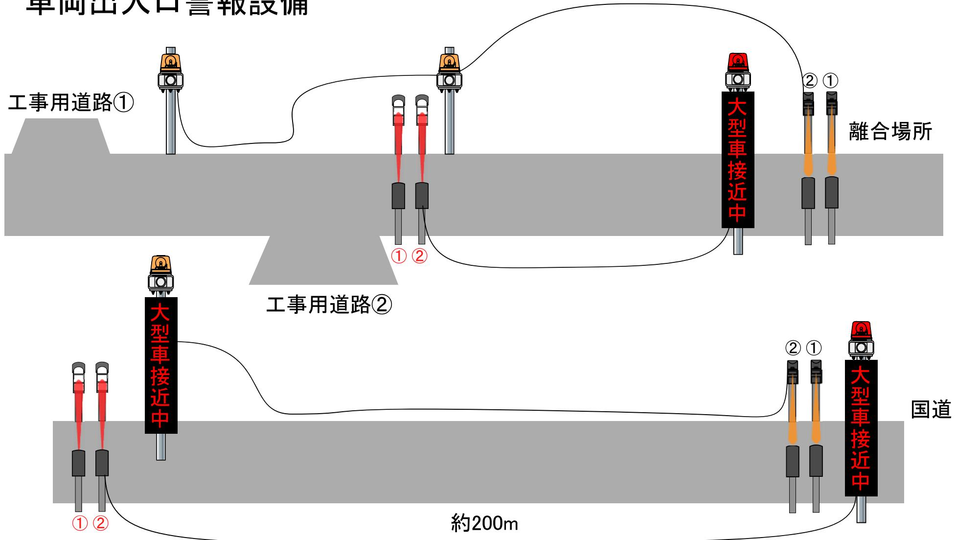
工事用道路から国道へ車両が通過するとき、センサー赤が検知し警報音付パトライト赤が作動する。
