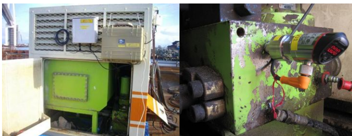
油圧式バイブロハンマの場合：油圧ユニットと圧力センサ
