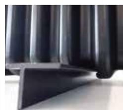
6. 樹脂製ですので、接続部で角度を振って曲げていくことが可能です。定尺も1mと短いので地形の凹凸に馴染ませ易い等のメリットがあります。
