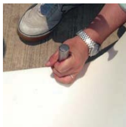
ポンチにて穴開け加工
