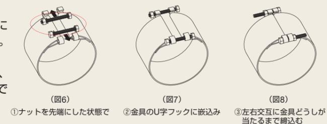
①ナットを先端にした状態で ②金具のU字フックに嵌込み ③左右交互に金具どうしが当たるまで締込む
