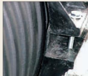
注) 2枚組の場合、片締すると破損するおそれがありますので、左右均等にボルト締を行ってください。
