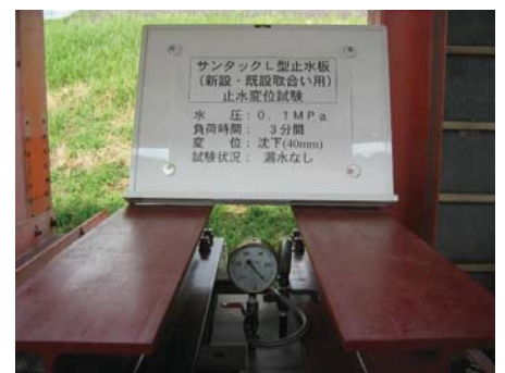
沈下量40mm/耐水圧0.1MPa
