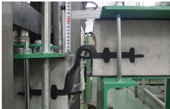
沈下変形100mm
