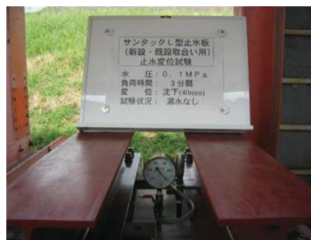
沈下量40mm/耐水圧0.1MPa
