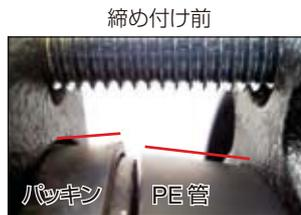
締め具合の目安はパッキンの外面の角度で判断ください。締め付け前は外面が、ほぼ平行または、PE管に対して逆テーパーですが、締め付け後は、管のテーパー部とほぼ平行になります。
