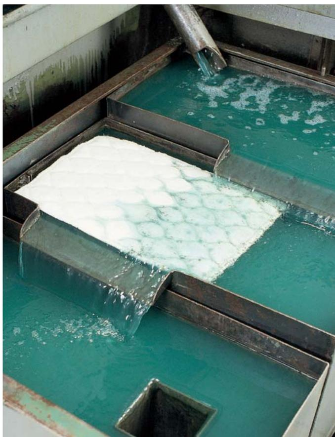
冷却水の液面に浮く油を除去し、高価な廃棄費用と交換費用を節約します。キルティングされたパッドは冷却水の液面でタンクに浮きます。また界面活性剤や洗剤が含まれていても沈みません。
